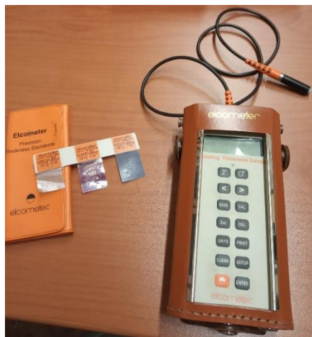
Figura 16: Medidor de espessura Elcometer®
